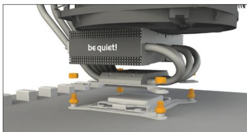
Setzen Sie die Sechskant-Muttern (8) auf die Distanzmuttern (7) und ziehen Sie diese mit Hilfe des Maulschlüssels (14) kreuzweise handfest an.
