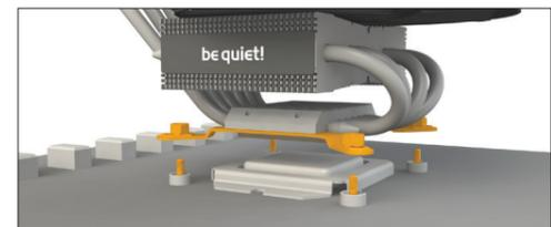
von der Rückseite des Mainboards mit den an dem Kühler befestigten Sechskantmuttern mit Hülse (6) verschrauben lassen.
