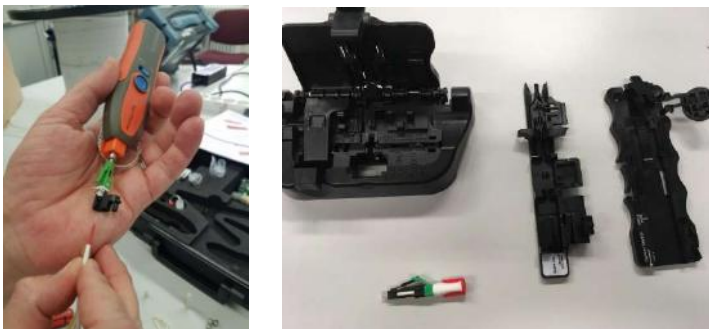
Abbildung 37: Herstellung LC-APC mit mechanischem Spleiß; links FO-Field, Fa. Reichle de Massari; rechts Fa. Corning (Quelle: DT)
