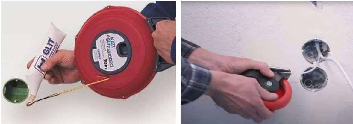
Abbildung 11: Auftragen von Kabelgleitmittel und Einziehgerät für belegte Leerrohre (Quelle: Fa. KATIMEX 9) )
