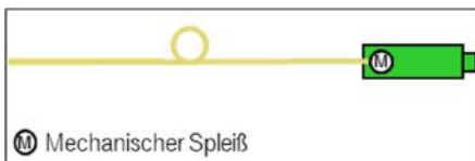
Abbildung 36: Prinzipdarstellung eines Steckers mit integriertem mechanischem Spleiß (Quelle: DT)
