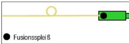
Abbildung 34: Prinzipdarstellung zur Konfektionierung eines „Spleißsteckers“ an ein Kabelende (Quelle: DT)
